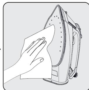
Pühkige kõik jäagid kodumasina välispindadelt ja tallaplaadilt (9) niiske lapiga ning vajaduse korral kerge mitteabrasiivse vedela puhastusvahendiga.
